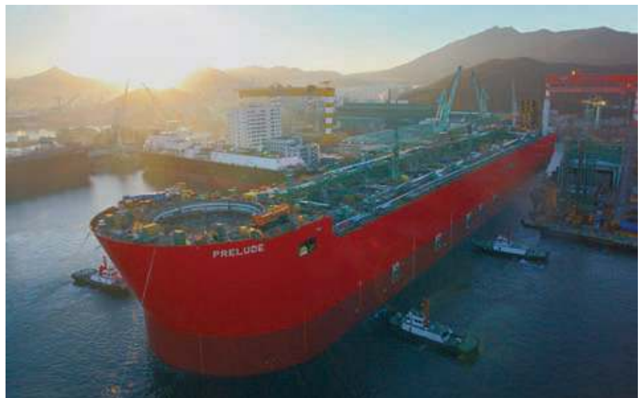
> El buque FLNG de Shell, “Prelude”, construido en astilleros coreanos es, hasta la fecha, el mayor buque del mundo y representa la nueva tecnología aplicada al gas natural convencional. Botado en diciembre de 2013, tiene 488 metros de eslora por 74 de manga y alberga una planta de licuefacción de gas natural a flote que cargará directamente los buques tanque GNL que se abarloan a su costado. Cuando sea completado, se instalará en los yacimientos gasísticos de Australia.
