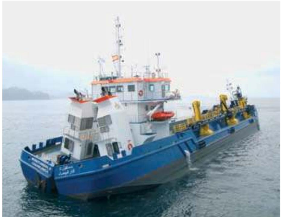
> El casco de la draga se abre longitudinalmente y permite un rápido vaciado de la arena extraída.
