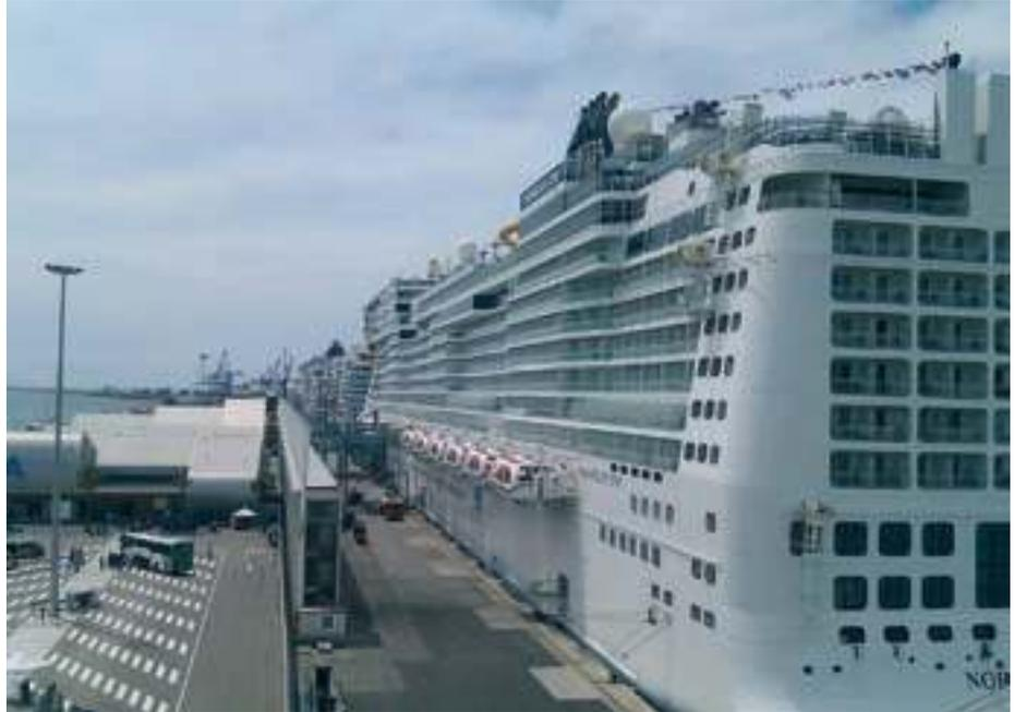
> El “Norwegian Epic” en la Terminal A del Muelle de Adosados. Entre el costado del buque y el edificio de la Terminal se instalan las pasarelas. La elevada “fachada” de los buques es sensible al viento y los amarres necesitan de la máxima firmeza para evitar problemas de desconexión durante los embarques y desembarques.
