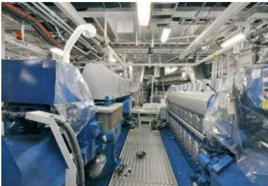
> Los cuatro generadores Wärtsilä proporcionan 6.320 kW a dos hélices acimutales Schottel. (Foto La Naval.)
