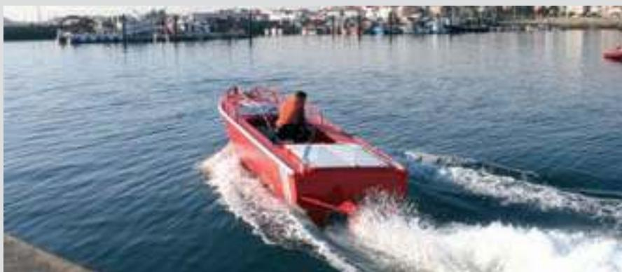
> Un *speedboat* construido por López Villar. La embarcación viaja a bordo de los atuneros y efectúa rápidas pasadas durante el largado de la red, asustando al pescado para que no escape del perímetro aún sin cerrar. Completado el cerco, y mientras se cierra el fondo de la red con la jareta, el *speedboat* hace ruidosas pasadas al costado de estribor del atunero para que el banco atrapado no huya pasando bajo la quilla del buque.
