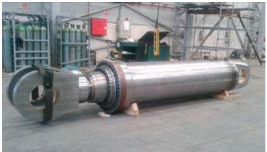
> Los cilindros hidráulicos tienen una fuerza de 822 Tn cada uno, y permiten abrir los cascos 45°, lo que supone una apertura en el fondo de casi 4 m entre los mismos.
