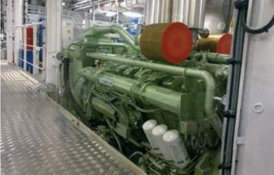
> Motor auxiliar Guascor (Dresser Rand) en la sala de máquinas de un atunero.
