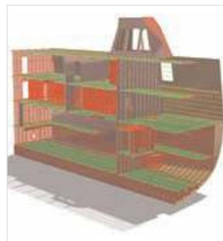
> Modelo de diseño 3D de estructura básica.
