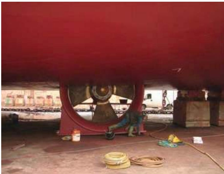
> Con el VGP, la lubricación de mecanismos sumergidos, como esta hélice retractable, precisa ser biodegradable, no acumulativa en el ecosistema marino y no tóxica.
