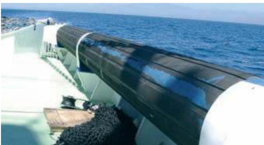
> El cilindro de caucho de estribor gira actuando como un halador secundario para izar la red a bordo.
