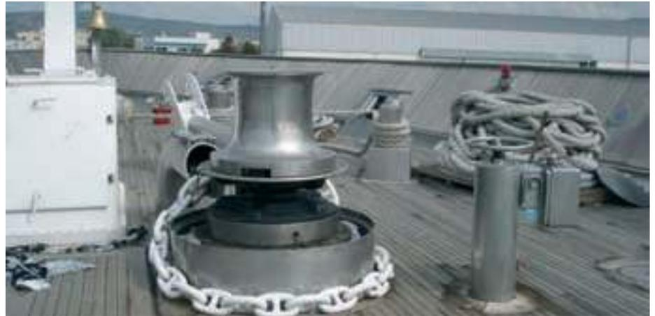
> El engrase biodegradable de la maquinaria de cubierta en el punto de mira del VGP.
