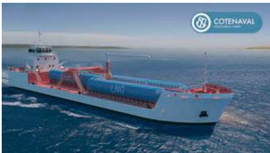
> Modelo de buque de suministro de combustibles convencionales adaptado al bunkering de GNL gracias a la instalación de tanques modulares en cubierta. (Imagen de CotenaVal.)
