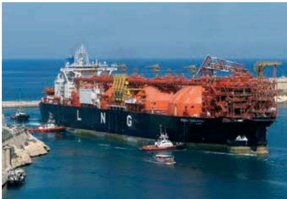
> El FSRU "Toscana" entra en la rada de La Valetta (Malta). Se aprecia la instalación de regasificación situada a proa, junto con la conducción para el envío, mediante 36,5 km de gaseoducto submarino, del GNL gasificado en la planta flotante. La planta se encuentra fondeada a 22 km de la costa italiana, entre Livorno y Pisa.
