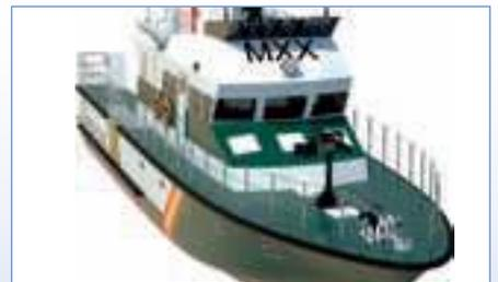
Patrulleras medias para navegación sostenida. Construidas en PRFV. Diseñadas y equipadas para misiones de vigilancia y lucha contra el narcotráfico y la inmigración irregular, además de la protección del medio marino en el ámbito de los cometidos de la Guardia Civil.
