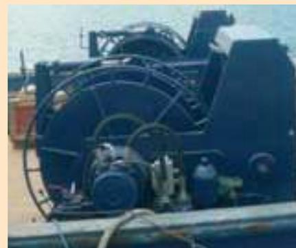
> Dos unidades de maquinas Split. Controladas con scanrol y sistema de filado hidráulico.
