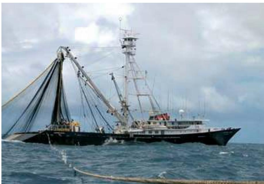
> Para la maniobra del largado y recogida de la red se necesitan una mecánica y propulsión a la medida.
