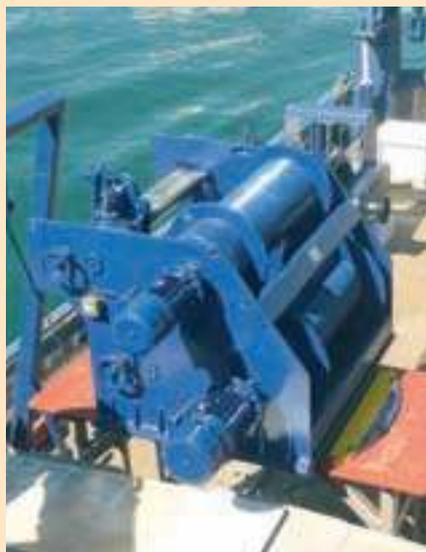
> Maquinilla oceanográfica con carretes dobles y giro de 90° para posicionamiento con relación al pórtico de estribor. Suministrada por Fluidmecánica tiene capacidad para 4.000 metros de cable coaxial que, permite la transmisión de señales en tiempo real, y cable acero inoxidable para batimetría.
