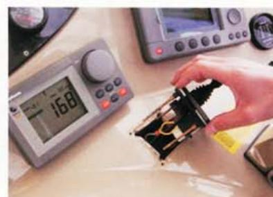
Para una hélice de proa basta con conectar los cables indicados a la base del control de ésta.
