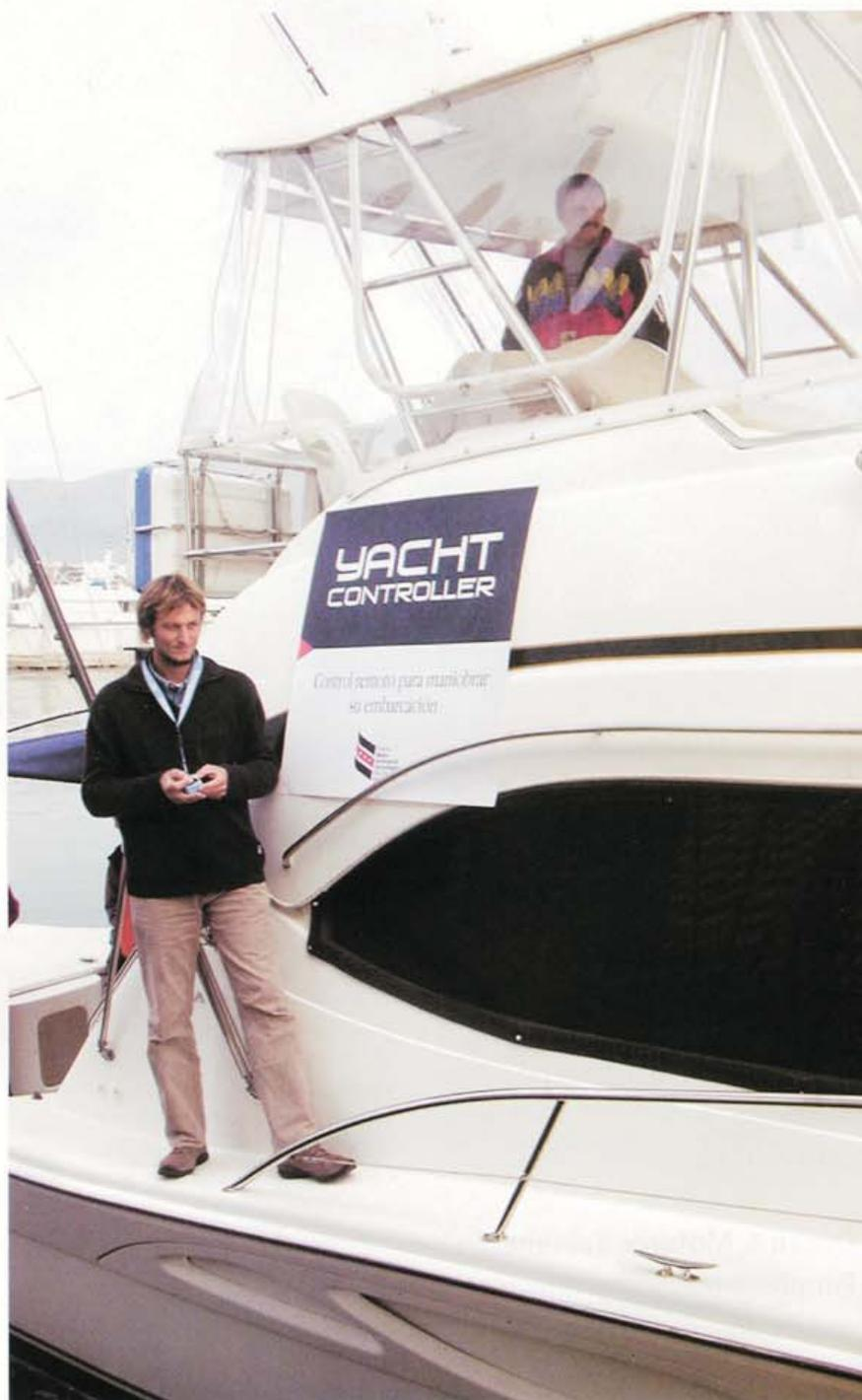
El mando a distancia Yacht Controller permite manejar las palancas de los motores desde cualquier punto del barco.
