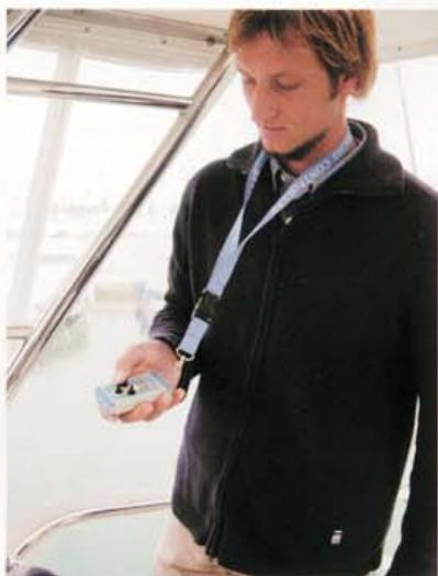
Con una sola mano se pueden manejar las dos palancas de los motores, el molinete de fondeo o la hélice de proa.
