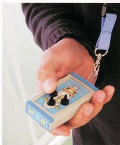
El Yacht Controller puede disponer de dos, tres o cuatro canales. El equipo es sencillo, y consta de un receptor con un emisor a distancia y un kit de conexiones adaptado a cada marca de mandos electrónicos.
