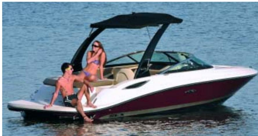
Con 7,34 metros de eslora esta deportiva de configuración bowrider, con proa abierta, es una de las lanchas más emblemáticas de la marca. El astillero propone con un dentrofueraborda a gasolina, 250 Hp con Mercruiser 5.0 L MPI, o en opción 300 Hp con Mercruiser 350 MAG con cola Alpha One o Bravo 3 DTS. Un puesto deportivo, solárium, modulo de servicio con lavamanos y numerosos huecos para estiba determina la amplia bañera de este diseño de proa abierta.
