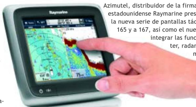
Azimutel, distribuidor de la firma de electrónica estadounidense Raymarine presentará en este Salón la nueva serie de pantallas táctiles multifunción a 165 y a 167, así como el nuevo e 165 capaces de integrar las funciones de chartplotter, radar, sonda, e incluso la monitorización de todos los datos e información de a bordo y los objetivos AIS.
