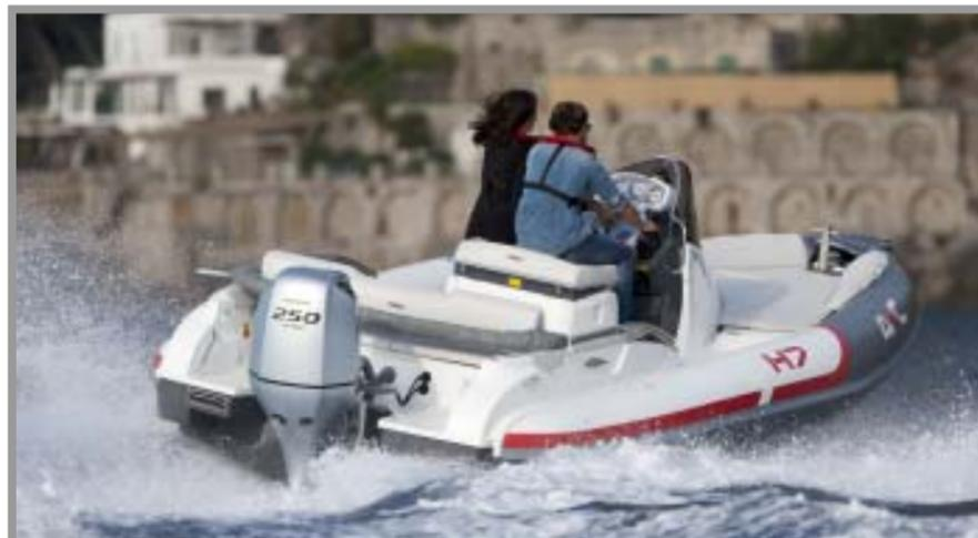
El BF250 combina un nuevo motor V6 de 3.6 litros, el mayor de la gama Honda, con el primer sistema de admisión de aire directa. Este nuevo sistema aumenta el rendimiento y disminuye el consumo de combustible.
