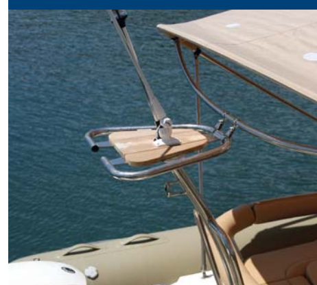
La torreta de antenas en popa.
