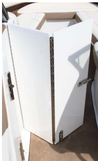
Una puerta plegable cierra totalmente el pasillo central protegiendo del viento.
