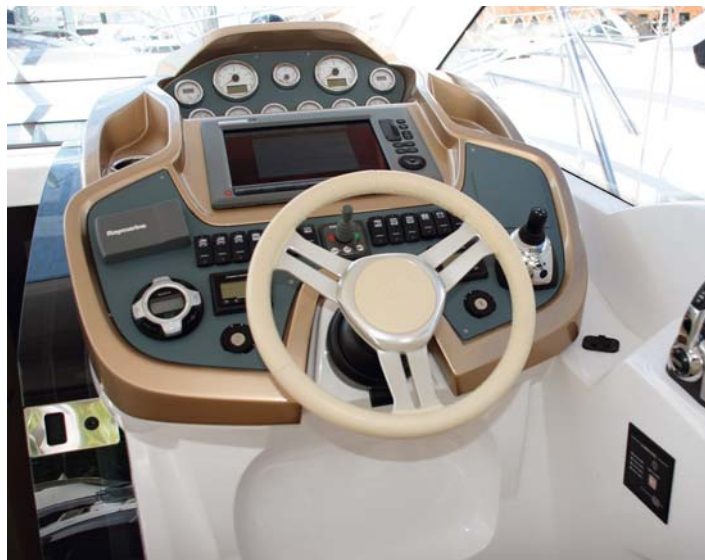
En la consola, los mandos del motor quedan separados de la zona de electrónica.
