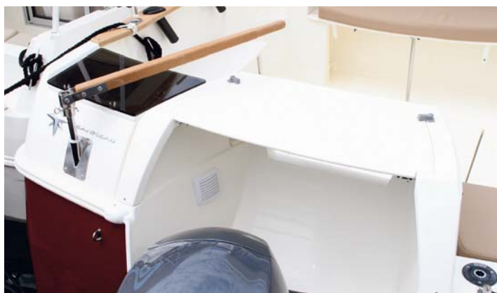
Junto a la caña de respeto, una tapa crea una superficie de trabajo.
