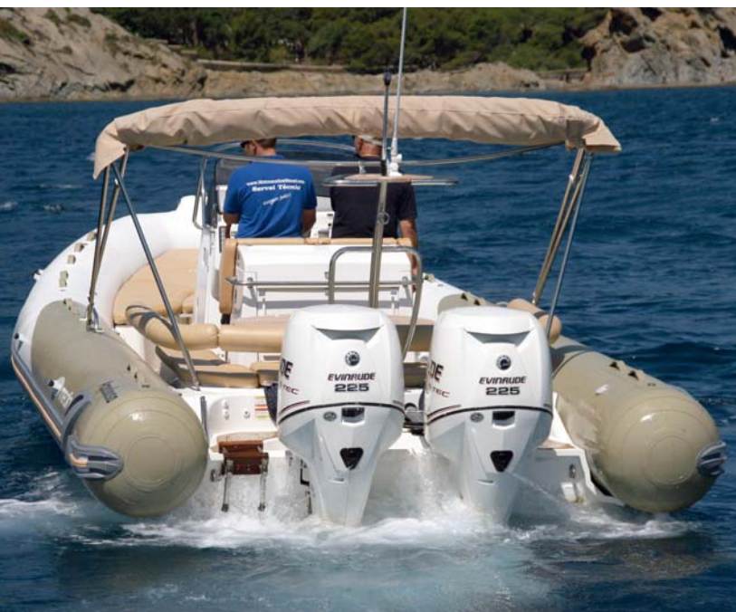
Los flotadores quedan ligeramente elevados con la embarcación parada.
