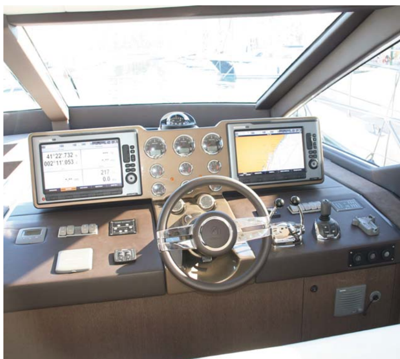
La altura de la consola ha sido bien dimensionada para no limitar la visión frontal
