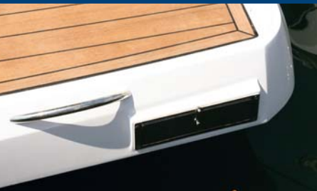
La escalera de estiba interna.
