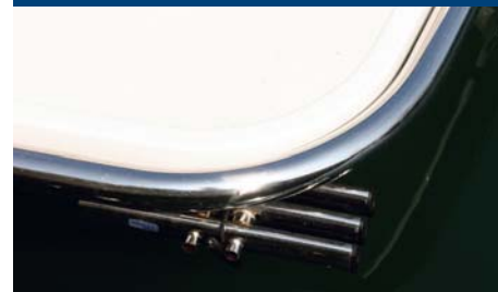
La escalera tipo buceo.
